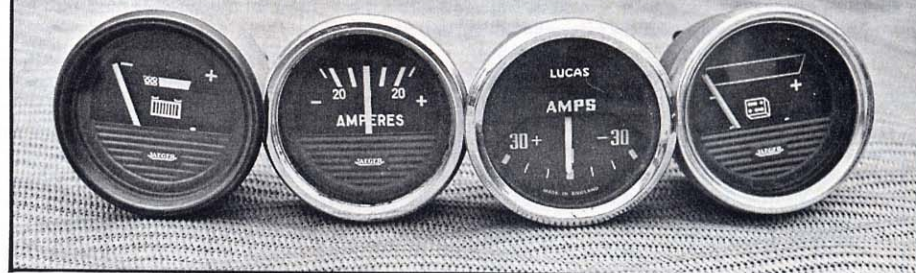
A gauche et à droite, deux voltmètres, au centre, deux ampèremètres.
