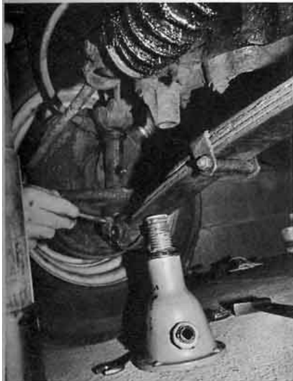
A l'aide d'un cric annexe ou de tout autre ustensile, soulagez la lame de ressort afin de dégager l'axe du pivot. Répétez l'opération de l'autre côté.
