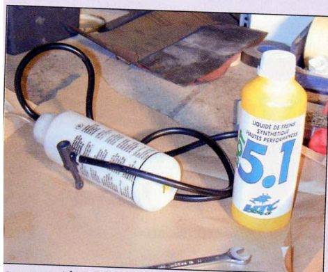
La purge peut être réalisée seul, avec l'aide d'un autopurgeur. On utilise un bouchon étanche fixé sur le bocal et une chambre à air de votre pneu. Il faut ensuite pomper sur le pneu pour pousser le liquide dans le circuit. Il faut ensuite remplacer le mollet et le pied d'un partenaire.
