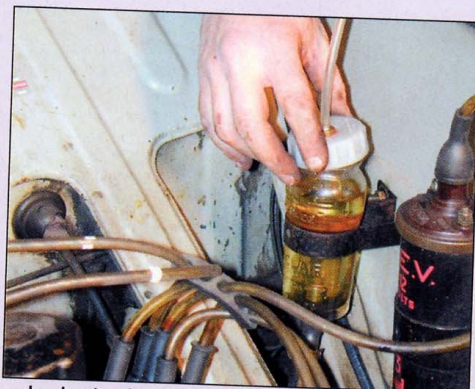
La purge peut être réalisée seul, avec l'aide d'un autopurgeur. On utilise un bouchon étanche fixé sur le bocal et une chambre à air de votre pneu. Il faut ensuite pomper sur le pneu pour pousser le liquide dans le circuit. Il faut ensuite remplacer le mollet et le pied d'un partenaire.
