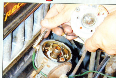
2 Brancher le fil d'alimentation de la lampe témoin sur l'allumeur, côté arrivée de l'alimentation.
