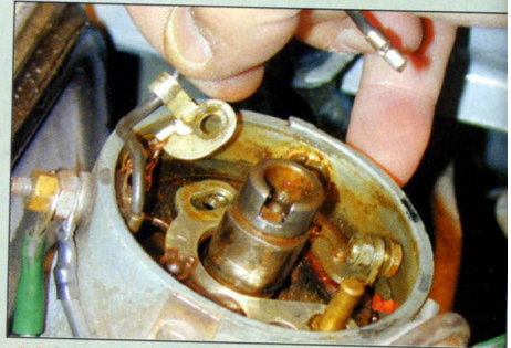
12 Cette partie fixe doit être à la masse. On en profite pour vérifier que la tresse de masse est en bon état.
