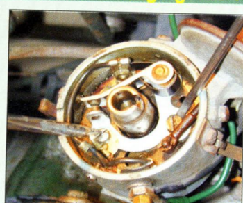
10 On règle l'écartement des contacts en agissant sur la vis excentrique (vis de droite sur la photo).
