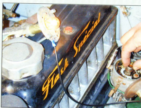
5 En tournant alors légèrement l'arbre d'allumeur, la lampe témoin doit s'allumer. En fait, le touchot s'éloignant du bossage (ou came), le grain de contact du linguet s'écarte du grain de contact du support fixe, provoquant un arc électrique. Cet instant précis d'allumage s'appelle le point de rupture.
