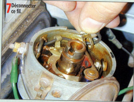
8 Contrôler l'état du fil qui ne doit pas être dénudé, ce qui pourrait provoquer une fuite de courant qui affaiblirait les étincelles produites.
