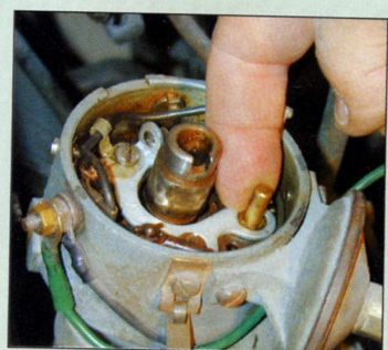
3 Graisser légèrement l'axe de rotation du linguet.
