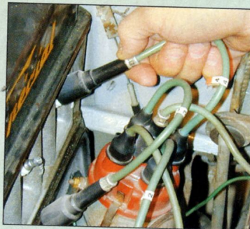
2 Déposer les fils de bougies et le fil qui relie la bobine à la tête d'allumeur.
