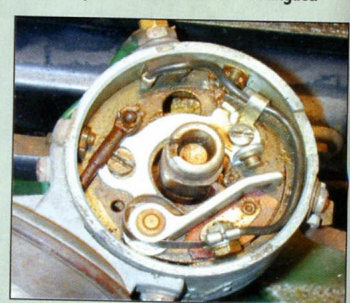
8 ... amener un bossage (ou came) de l'arbre d'allumeur en contact avec le touchot du linguet. Puis remettre l'auto au point mort.
