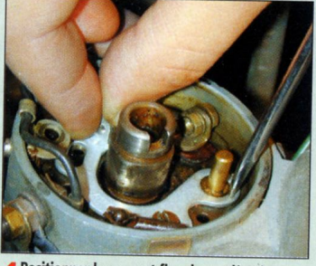
1 Positionner le support fixe de manière à ce qu'il soit bien pris dans l'épaulement, sous l'axe de rotation du linguet.
