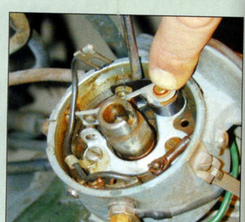
4 Mettre en place le linguet en faisant attention à bien positionner le "ressort" du linguet.
