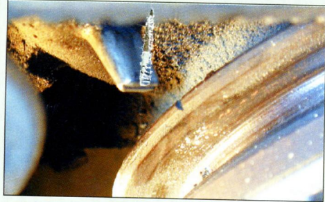
1 Enclencher la quatrième vitesse. Mettre en face le repère de la poulie avec le repère fixe situé sur le bloc. Puis remettre la voiture au point mort.
