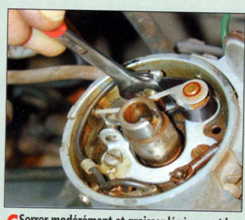
6 Serrer modérément et graisser légèrement le touchot du linguet (la partie qui vient en contact avec les cames sur l'arbre d'allumeur).
