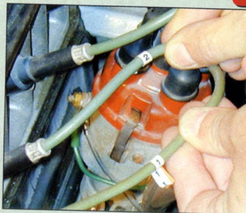
1 Repérer chaque fil de bougie en lui attribuant un numéro. En général, on numérote en partant du cylindre le plus proche de la pompe à eau.
