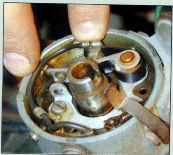
5 Mettre en place le fil sur le linguet (voir photo 7 du "Démontage").
