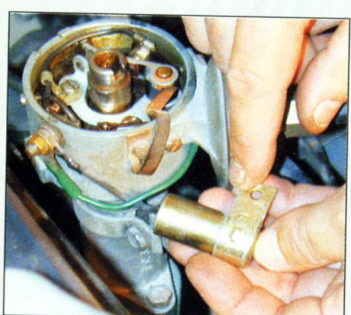
14 Déposer et remplacer le condensateur.
