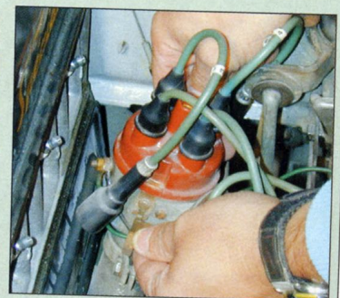
3 Dégrafer les deux clips de maintien de la tête d'allumeur.
