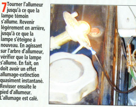
7 Tourner l'allumeur jusqu'à ce que la lampe témoin s'allume. Revenir légèrement en arrière, jusqu'à ce que la lampe s'éteigne à nouveau. En agissant sur l'arbre d'allumeur, vérifier que la lampe s'allume. En fait, on doit avoir un effet allumage-extinction quasiment instantané. Revisser ensuite le pied d'allumeur. L'allumage est calé.
