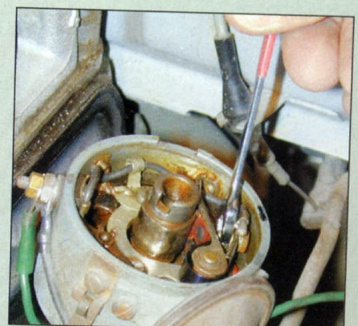
6 Dévisser l'écrou de maintien du fil qui part du linguet pour aller vers la borne de connexion.
