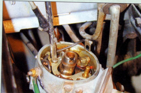
11 Déposer la vis de maintien de la partie fixe du rupteur.
