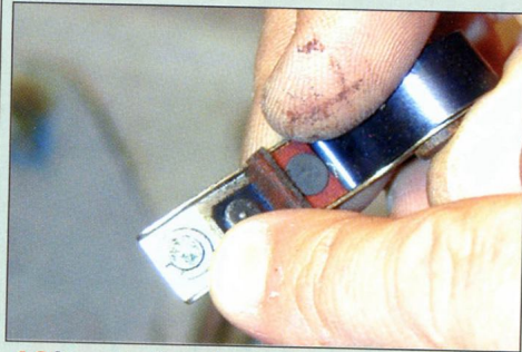
10 On constate vite que le grain de contact ne touchait que sur un côté. La rupture ne se faisait pas très bien.
