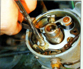
12 Une fois le réglage réalisé, bloquer la vis de maintien du support fixe.
