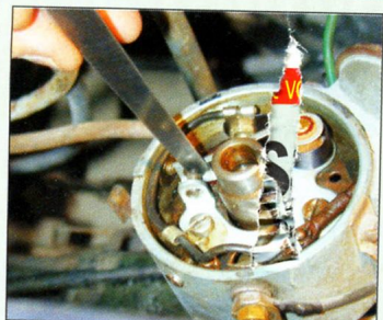
9 L'écartement se mesure à l'aide d'une cale placée entre les deux grains de contact du rupteur.
