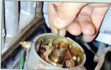
8 Contrôler l'état du fil qui ne doit pas être dénudé, ce qui pourrait provoquer une fuite de courant qui affaiblirait les étincelles produites.
